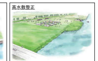
高水敷調整 かさ上げを行い整備 T.P. 2.0m程度
