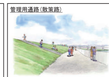
管理用通路(散策路) 通路幅 4～6m T.P. 3.5m
